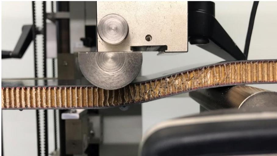
Abbildung 39 Sandwich-Probe bei maximaler Verformung
