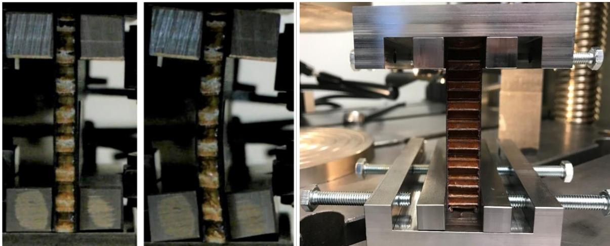
Abbildung 15 Einspannung der Proben in Vorgängerarbeit (li) [1] und in dieser Arbeit (re)
