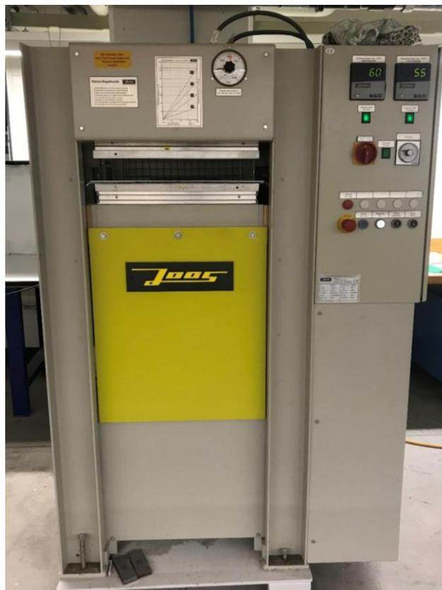
Abbildung 9 Verwendete Heizpresse
