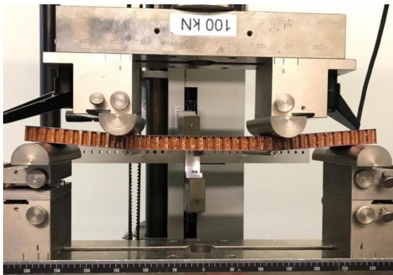
Abbildung 20 Biegeprobe nach dem Versuch
