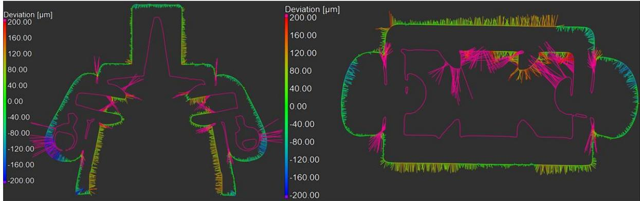
Abbildung 23: Soll-Ist-Vergleich Legomann Oberteil, farbcodierte 2D-Schnittbilder in Frontalansicht (links) und Transversalansicht (rechts)
