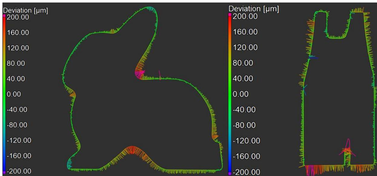
Abbildung 18: Soll-Ist-Vergleich Holzhase, farbcodierte 2D-Schnittbilder in Seitenansicht (links) und Frontalansicht (rechts)
