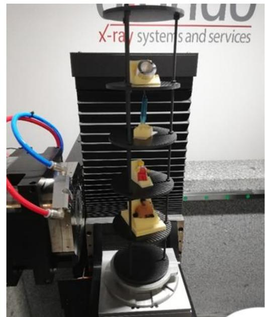
Abbildung 7: Messaufbau mit Etage
