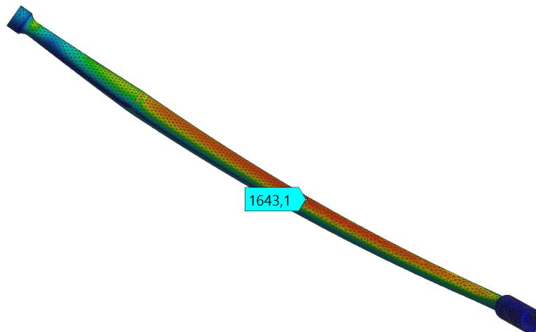
Abbildung 2.12: Maximale Vergleichsspannung bei „limit load“ (linear-elastisch)
