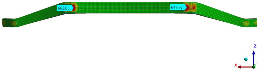
Abbildung 4.18: Zugspannungen in Z-Richtung am Obergurt „ultimate load“
