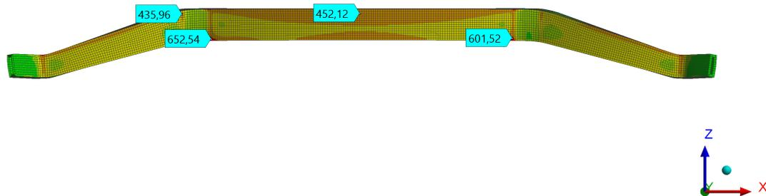
Abbildung 4.20: Zugspannungen in X-Richtung am Untergurt „ultimate load“
