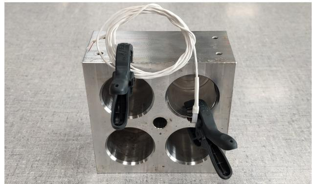
Abbildung 5.6: Einbaulehre in Probenträger
