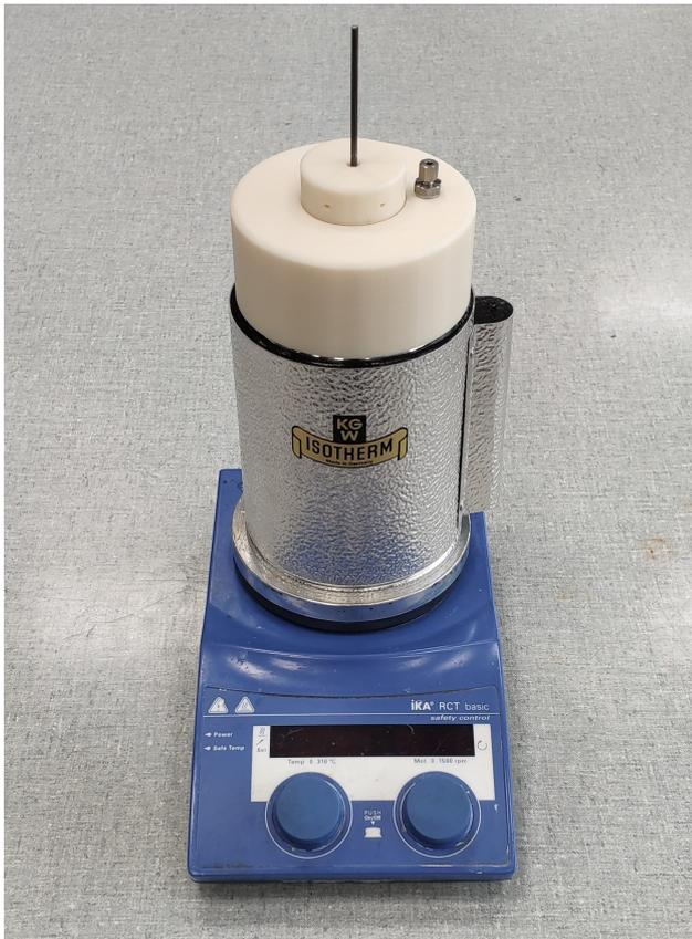
Abbildung 6.3: Aufbau Drop Kalorimeter
