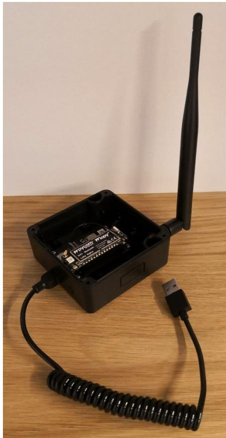
Abbildung 12: Verwendetes LoRa Modul (LoPy)
