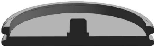
Abbildung 9 - Kolben mit einer Dichtung
