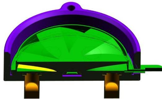
Abbildung 13 - Verschluss Einsatz "geschlossen"
