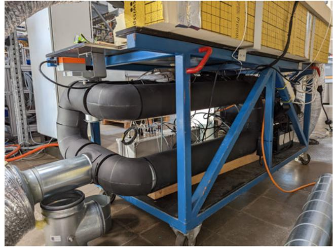
Abbildung 4.4: Umgebauter Prüfstand mit Trocknungskolonnen, Bypasskanal und Bypassklappe.
