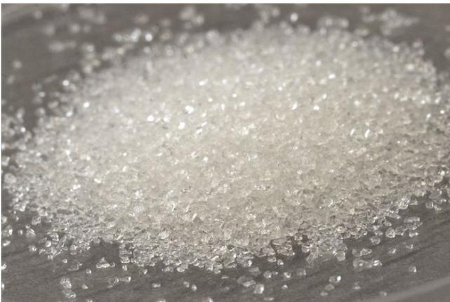
Abbildung 3.8: Silicagel als Pulver mit Korngrösse 0.2 - 1.0 mm [12]
