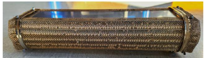
Abbildung 4.1: Trocknungseinsatz mit Molekularsieben aus Zeolith für die Lufttrocknung im Trocknungskanal.
