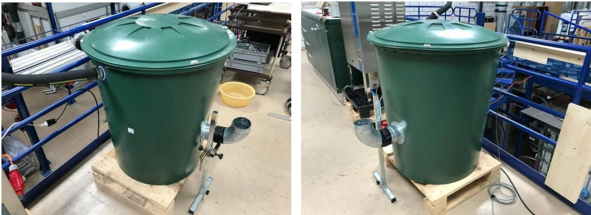
Abbildung 18: Dampfbehälter und die Anschlüsse
