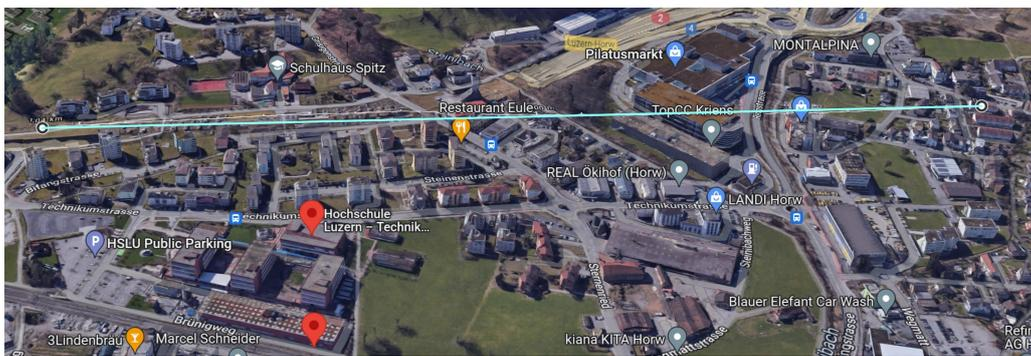
Abbildung 41: Reichweite des tinyLoRa.2 mit Ping-Pong-Applikation
