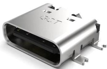
Um Programme auf den RP2040 zu flashen oder die Akkuzelle zu laden, wird ein USB-Anschluss benötigt. Durch die immer grössere Verbreitung wird beim tinyLoRa dafür eine USB-C Buchse verwendet, genauer die USB4110-GF-A Buchse vom Hersteller GCT. Es handelt sich dabei um eine SMD Variante.
