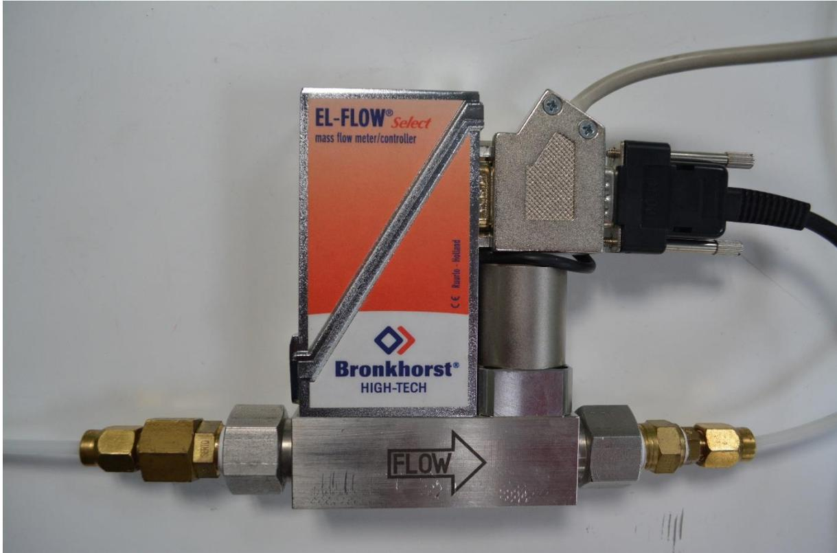
Abbildung 14: Massendurchflussregler für Gas mit 0.05mg/s bis 2.5mg/s
