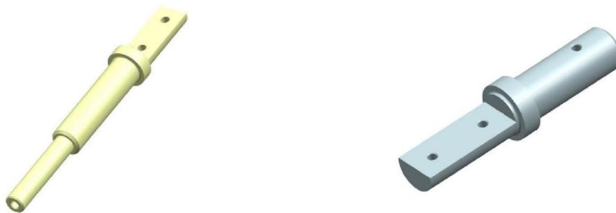
Abbildung 18: CAD Modelle von Rotorachse (links) und Motorwelle (rechts)
