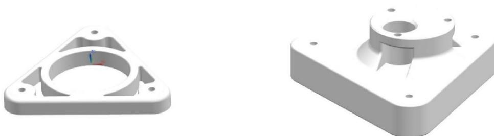
Abbildung 19: CAD Modelle von Sockel (links) und Lagerplatte (rechts)
