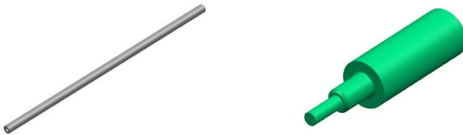
Abbildung 21: CAD Model von Stange (links) und Distanzbolzen (rechts)
