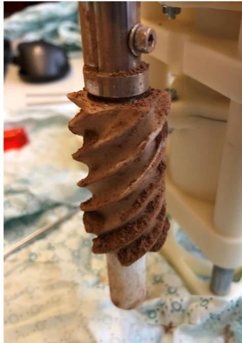
*Abbildung 41: Nachgearbeiteter Rotor nach dem Betrieb mit Schokoladenpulver*
