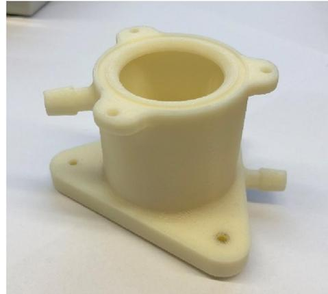
Abbildung 20: Düse Version 1 als CAD Model (links) und in echt (rechts)
