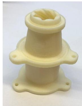
Abbildung 16: Stator Version 1 als CAD Model (links) und in echt (rechts)
