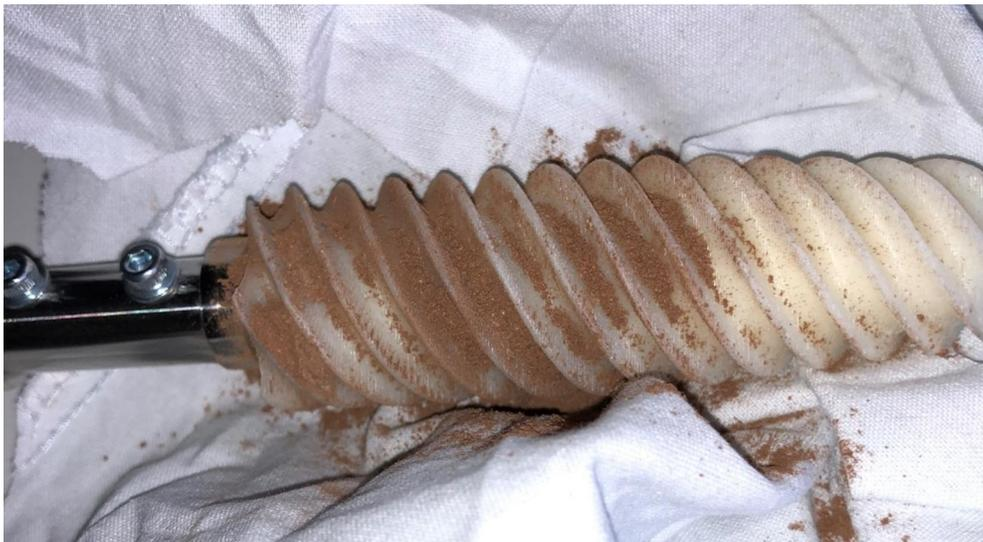
Abbildung 31: Rotor nach Betrieb mit Schokoladenpulver
