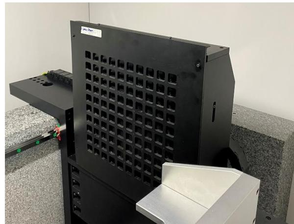
Abbildung 13: Detektor mit Streugitter
