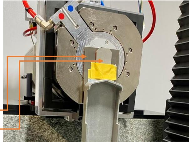
Abbildung 14: Quelle mit Kollimator und Filter
