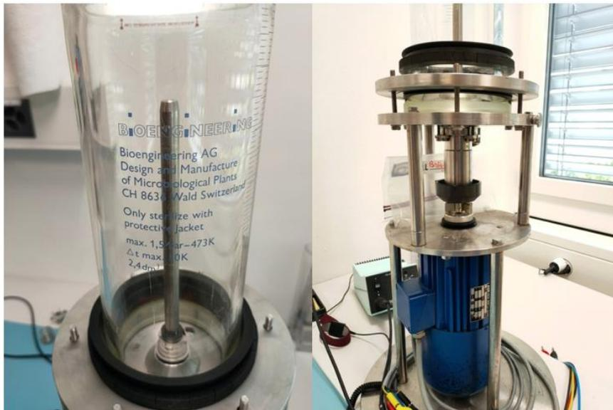
Abbildung 10 - links: Äussere Zylinder bzw. Bioreaktor; rechts: Antriebsmotor; Quelle: Eigene Aufnahme.
