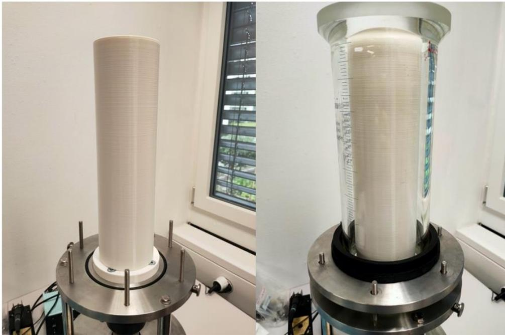
Abbildung 17 - Zusammengesetztes Taylor-Couette-System; Quelle: Eigene Aufnahme.
