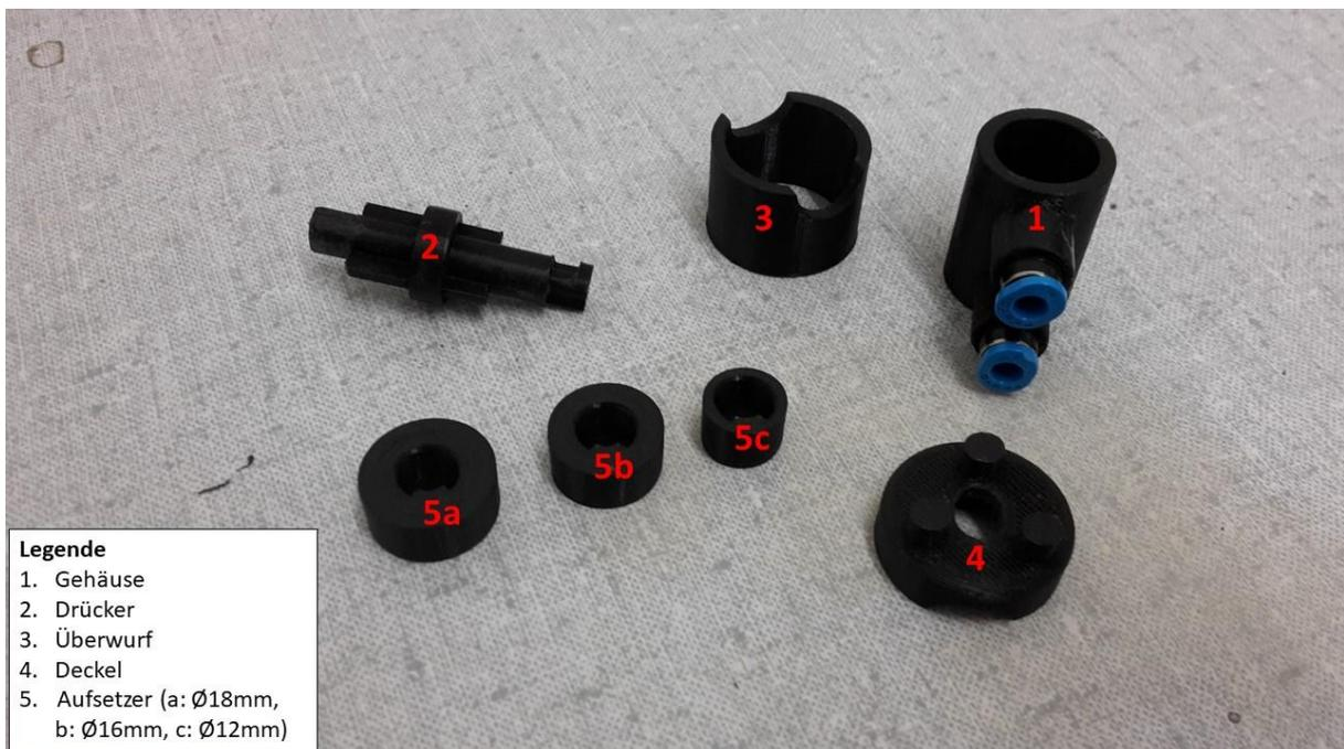
Abbildung 4: Einzelteile des Funktionsmusters Presslufthammer. Herstellungsverfahren: 3D-Drucker
