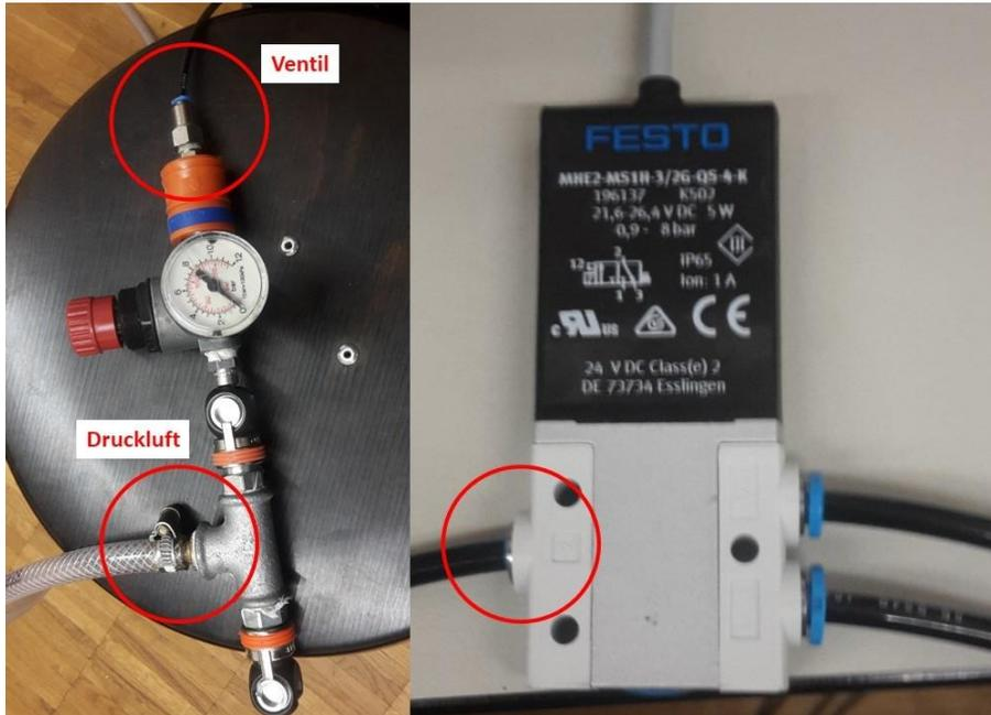
8. Ventil mit Vibrationssystem verbinden.
