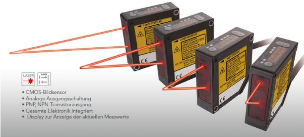
In puncto Genauigkeit macht den Sensoren der AWLG Serie kaum jemand etwas vor. Auflösungen ab 0.5 µm und eine Messfrequenz von bis zu 5.000 Hz zeigen deutlich wie performant diese Serie ist. Dank der neuesten Lasertechnologie und dem CMOS Sensor ist eine hohe Farbunabhängigkeit auch auf schwierigen Oberflächen garantiert. Doch auch die Ausstattung des Sensors kann
