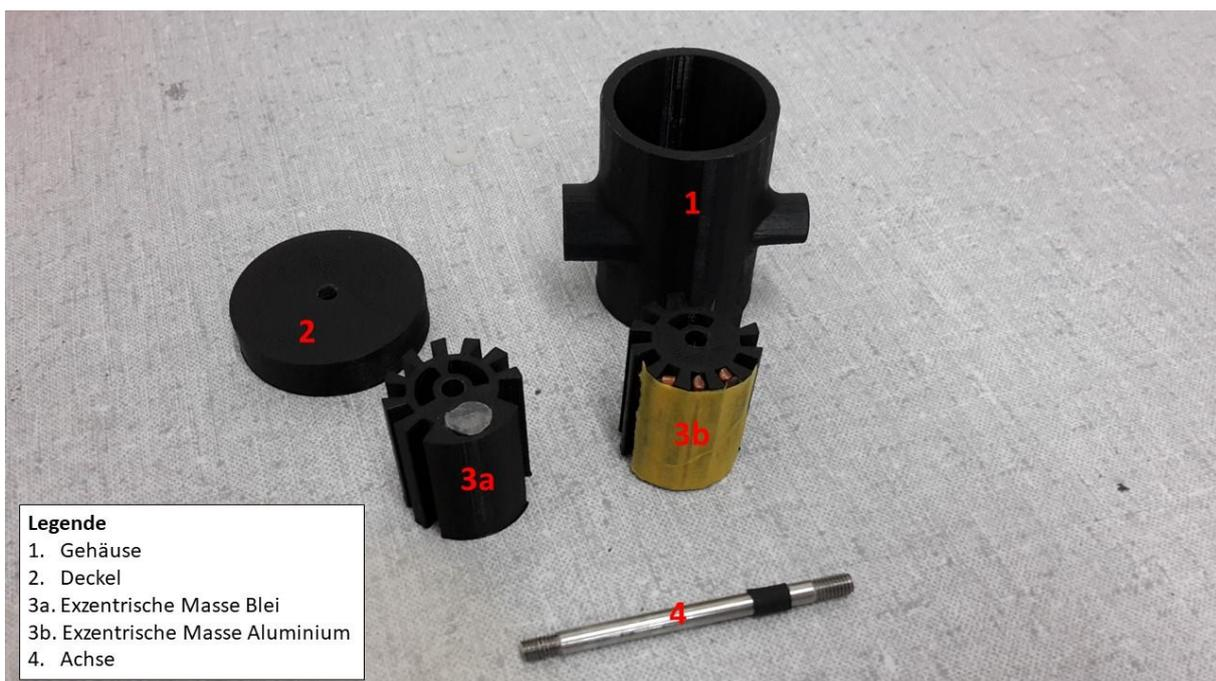
Abbildung 2: Einzelteile des Funktionsmusters Exzentrische Masse
