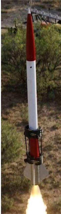
Abbildung 9: Fly Away Rail Guide System vom MIT
