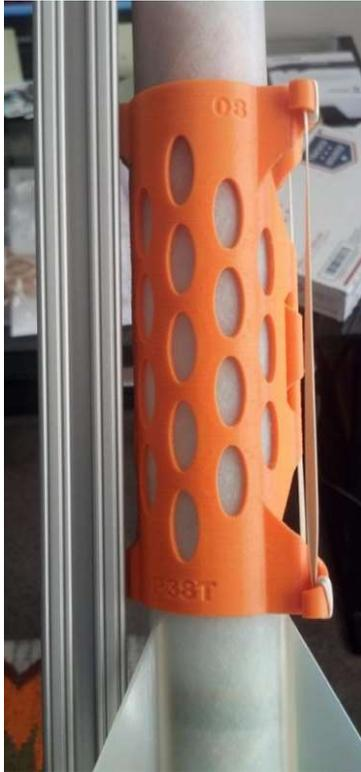
Abbildung 8: 3D gedruckter Fly Away Rail Guide
