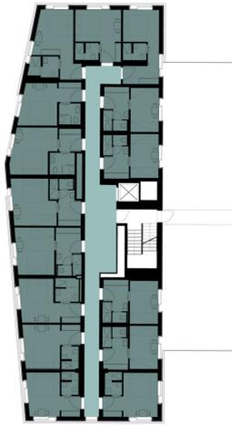
Abb. 46. Grundrissplan 1.-3.Obergeschoss
