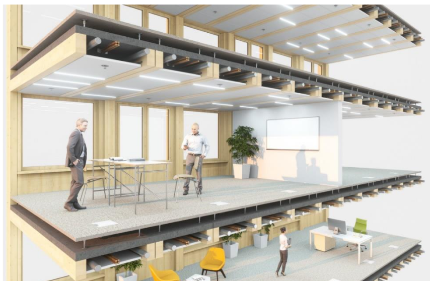
Figure 17: Hybrid ceiling slab/plate (ERNE AG Holzbau, 2017)
