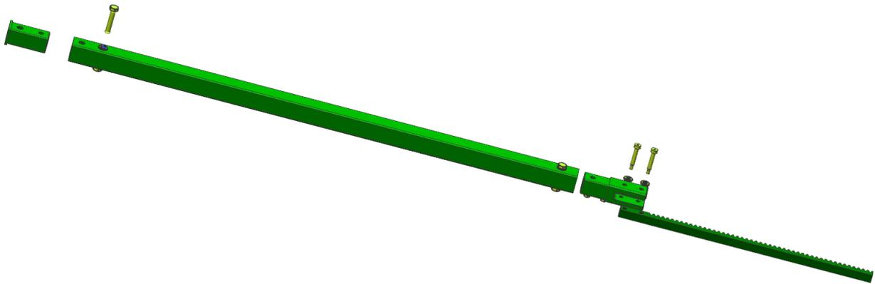
Abbildung 28 Explosionsansicht der Pendelstütze
