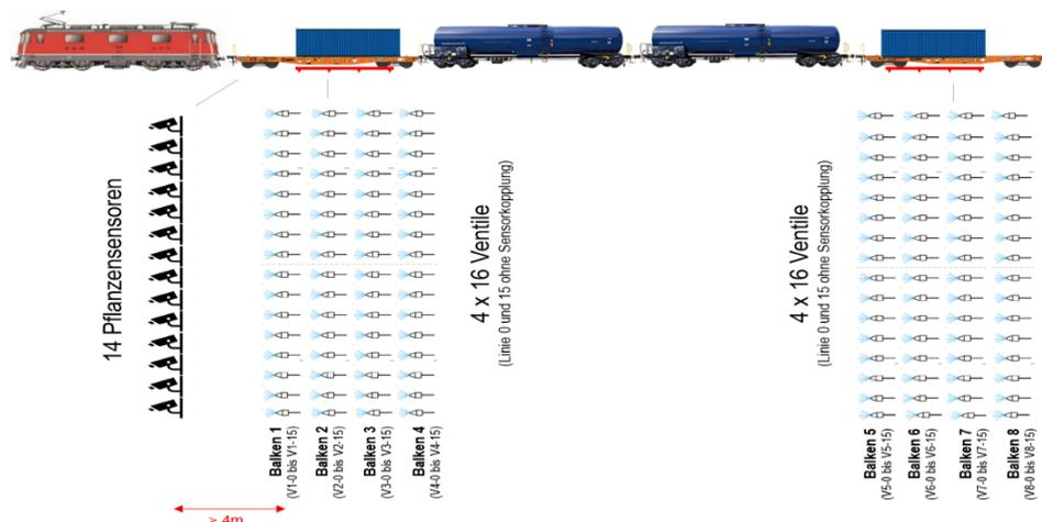
Abbildung 1 Prinzip Bild des Heisswasserspritzzug
